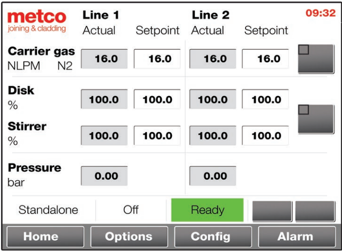
Metco Twin 150 -LC 粉末供給装置のタッチパネルホーム画面
